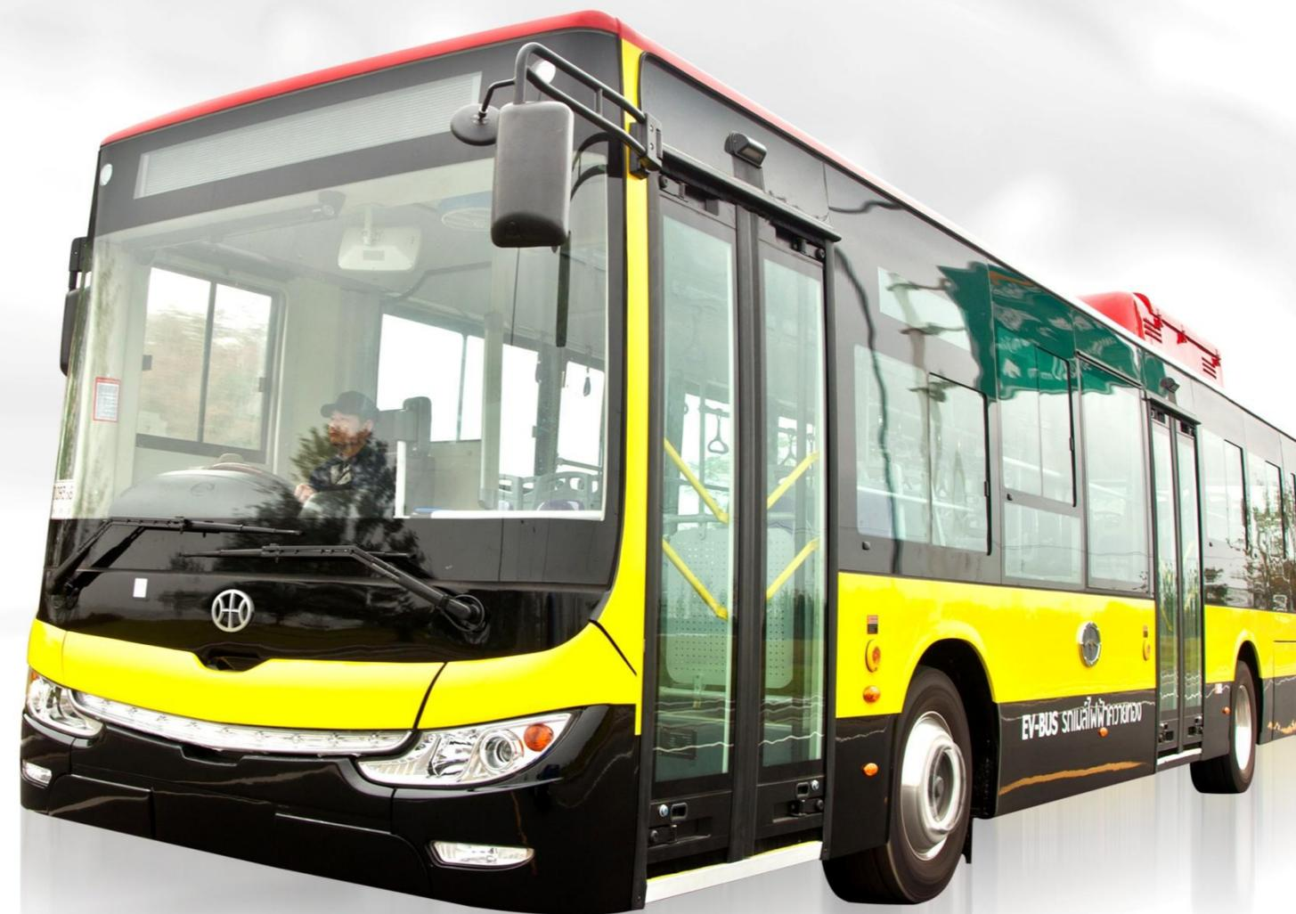
采用正道超級電池，可實現快速充電；根據城市公交綫路的長短定義動力電池的容量；采用750V、500A的高電壓、大電流充電機，單次充電10分鐘，最大續航裏程45公裏；滿充狀態最大行駛裏程110公裏。適合城市公共交通工況模式運行。能源效率和經濟性遠高于燃氣、燃油車，車輛在制動過程中，電機還可自動轉化爲發電機工作狀態實現滑行及制動減速時的能量回收。
